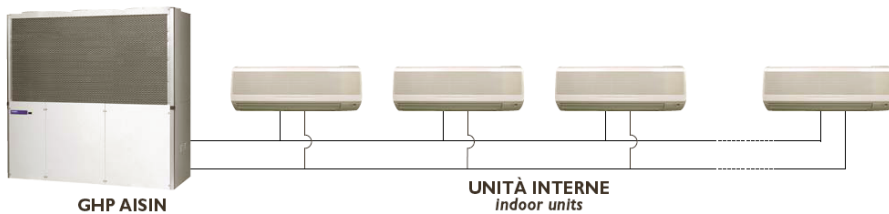
Slika 11. AISIN gasna toplotna pumpa i unutrašnje jedinice sa direktnom ekspanzijom
