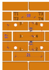
Slika 3. Zidovi od šuplje opeke – mjerna mjesta
