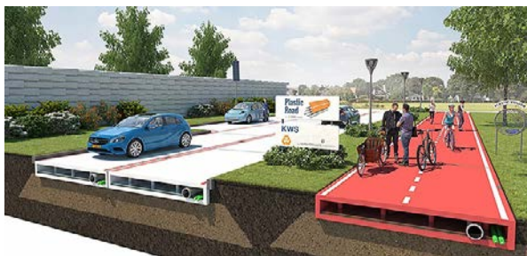
Plastični putevi su lakši što doprinosi smanjenju opterećenja podloge, foto: kucastil.rs
