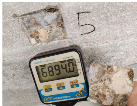
Ispitivanje i injektiranje pukotina na mostu, foto: G. Šegrt
