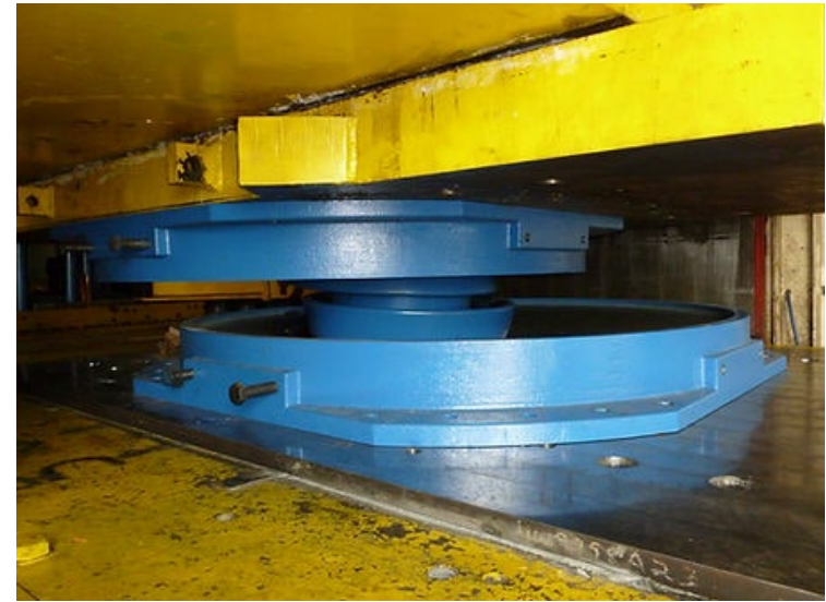
Bazna izolacija tipa klatna sa trenjem (FPS)
