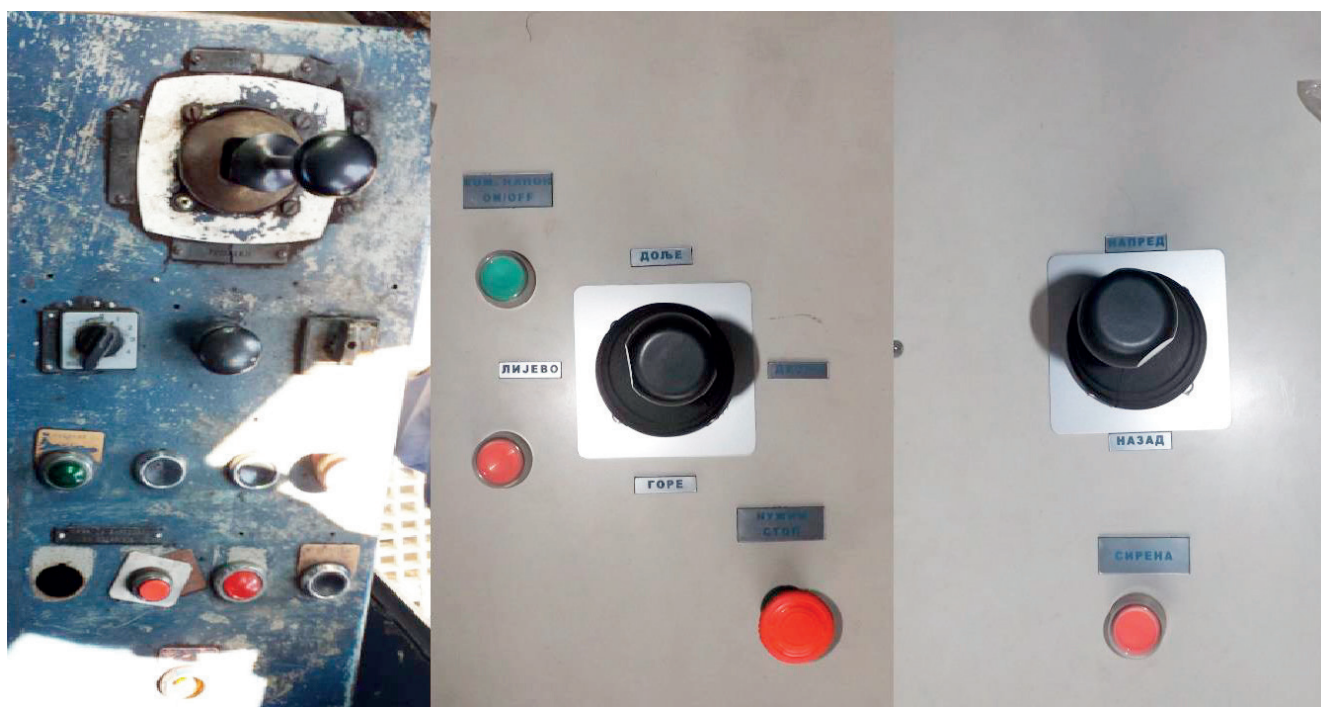
Slika 4. Izgled starog (lijevo) i novog (sredina i desno) komandnog pulta
