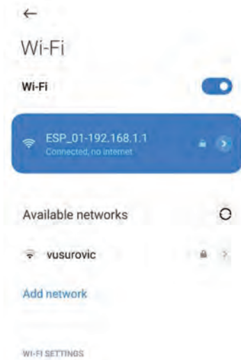
Slika 8. Access point mode Wi-Fi modula
