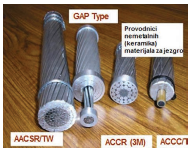
Sl. 12. Novi provodnici za dalekovode
