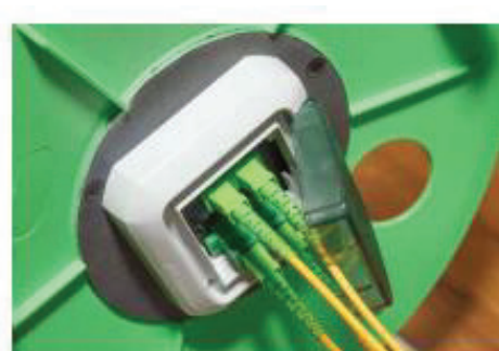
Slika 10:Optički patchcord u industrijskoj varijanti (izvor Optokon [4]).
