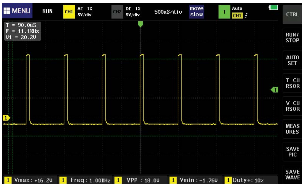
Slika 7: PWM signal na CP pinu, 6 A (radni ciklus – dutycycle = 10%)
