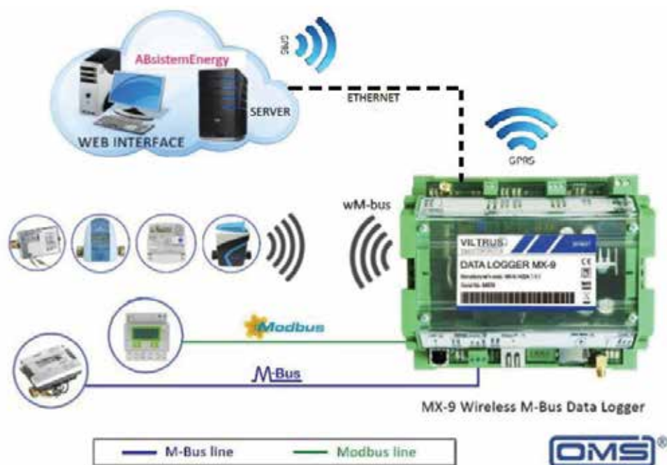
Slika 2. Šematski prikaz prikupljanja mjernih podataka na objektu [1]
