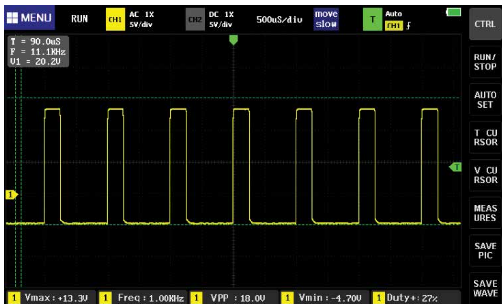
Slika 6: PWM signal na CP pinu, 16 A (radni ciklus – dutycycle = 27%)
