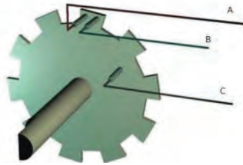
Slika 6. Položaj prekidača kod rotacionog enkodera [14]
