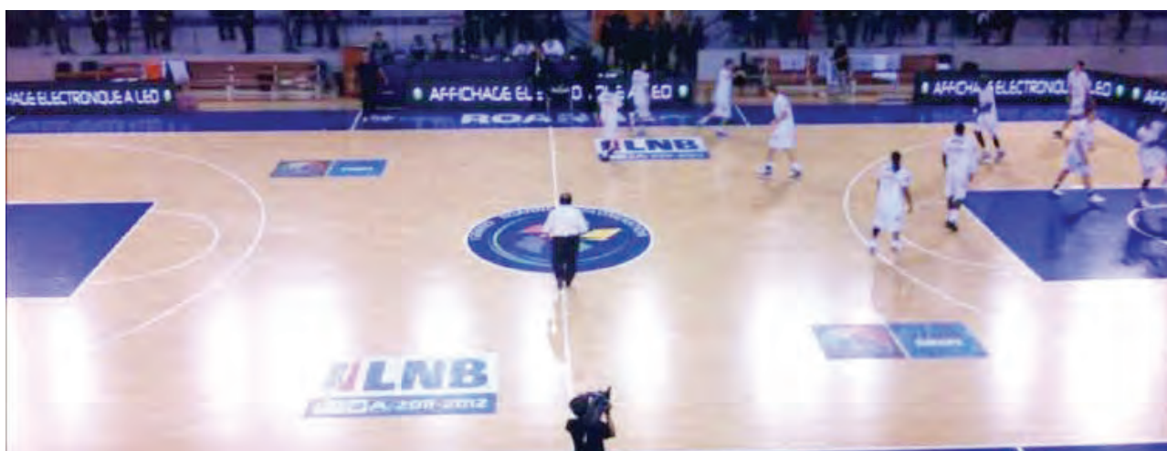
Slika 3. Neželjeno blještanje prema TV kameri
