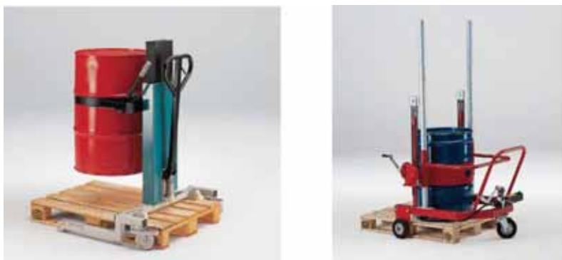
Sl.10.35 Ručna kolica za specijalnu namjenu-manipulaciju sa buradima
