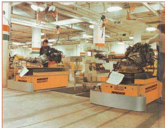
Sl.10.47 Vozila sa mogućnosti integracije u proizvodne/montažne linije
