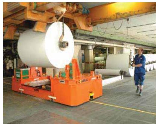
Sl.10.45 Automatski vođeno transportno vozilo za unutrašnji transport
