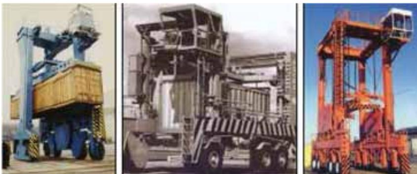
Sl.12.5 Opkoračivač vozila za vertikalno spuštanje i podizanje kontejnera
