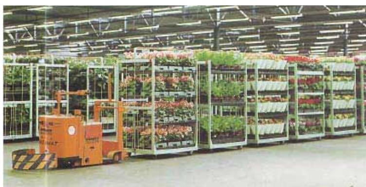
Sl.10.43 Automatski vođeni traktor za unutrašnji transport
