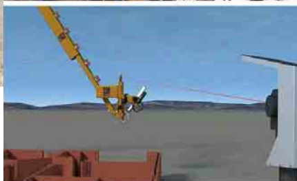
Robot "Hadrian" je unaprijedio proces zidanja foto: fastcompany.com
