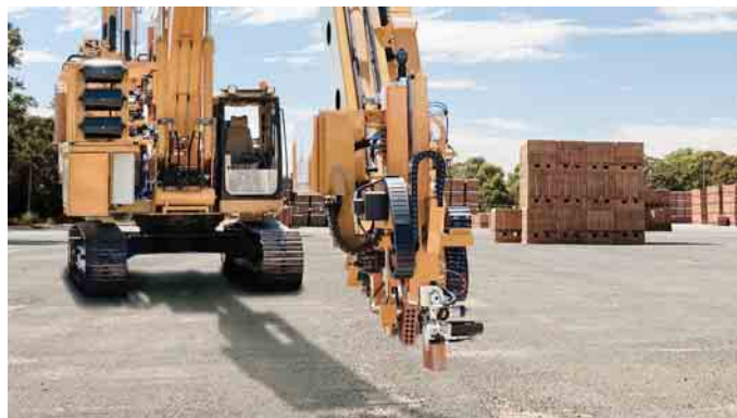
Robot "Hadrian" je unaprijedio proces zidanja foto: fastcompany.com
