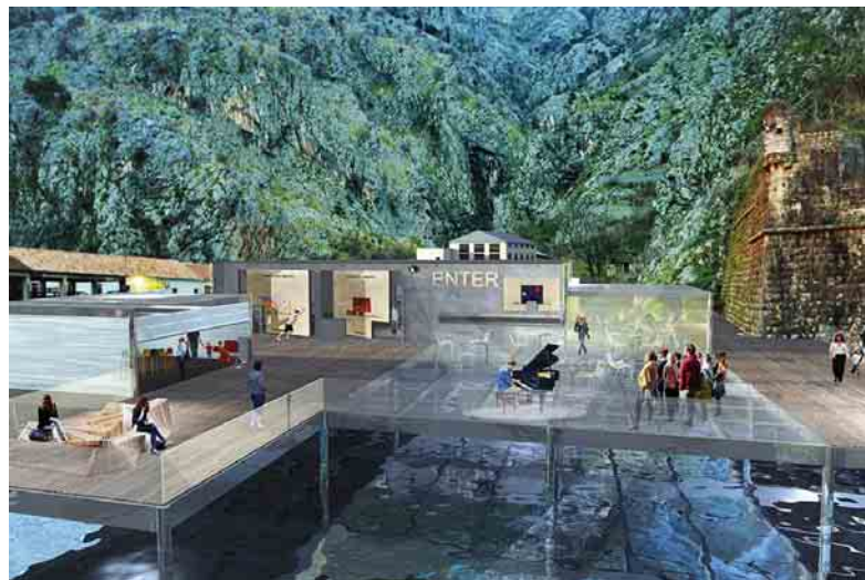
Cijeli kompleks leži na platformi koja stoji na čeličnim stubovima
