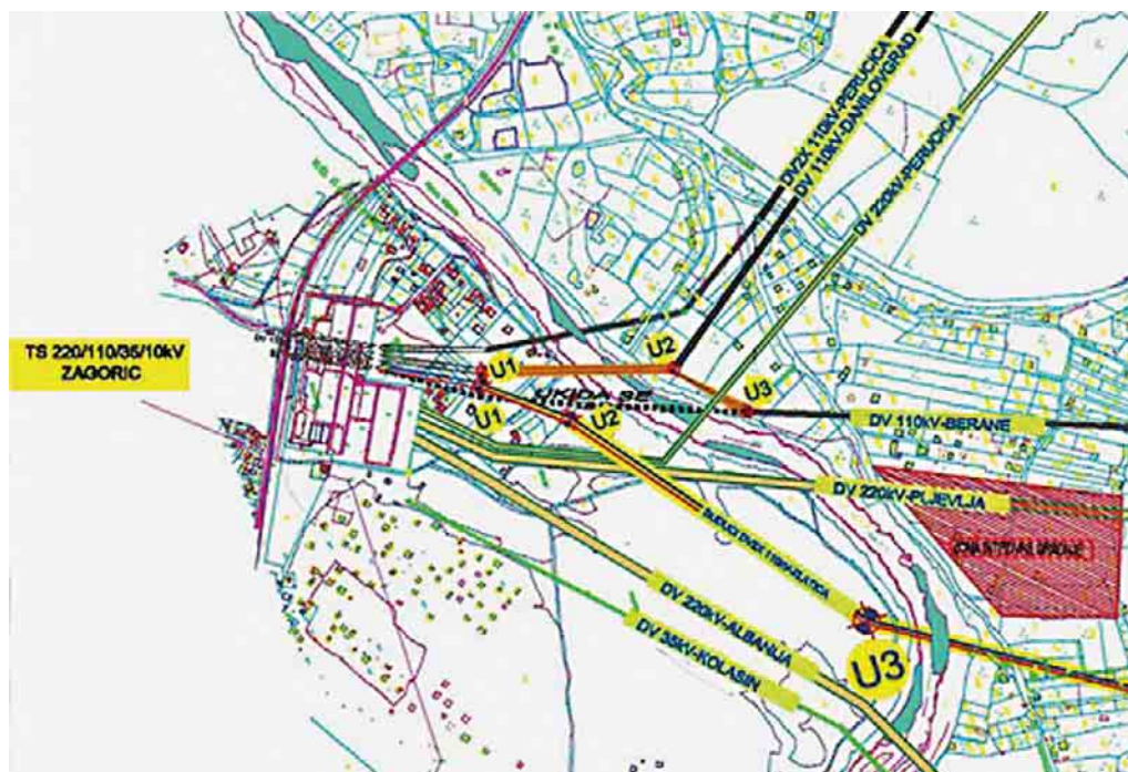
Rasplet DV110 kV kod TS Podgorica 1 zbog priključenja HE Zlatica na EES Crne Gore
