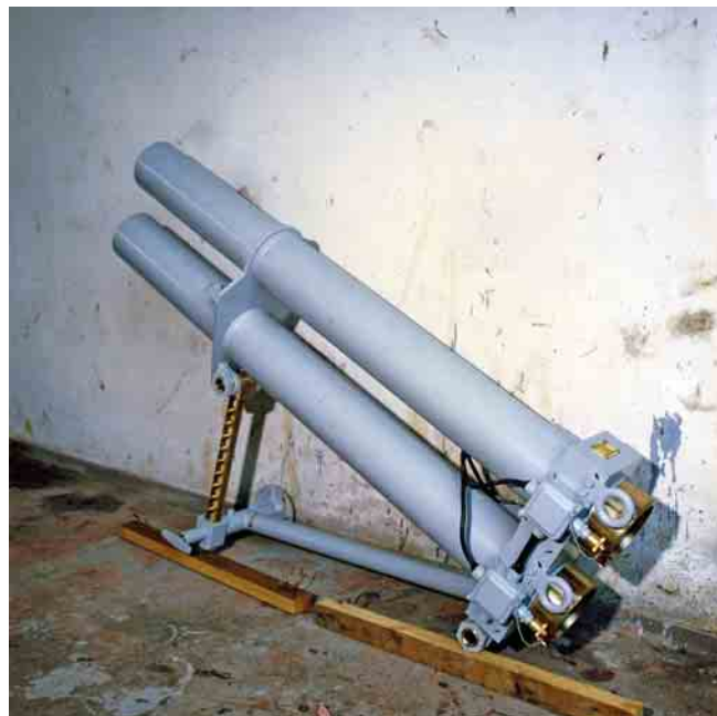
Lanser rakete za osvjetljavanje svitac kalibra 128 mm proizvođen u "Arsenalu"
